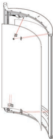
31. Schemat wymiany szyby w piecu ANTARES. / The ANTARES glass-replacement diagram
